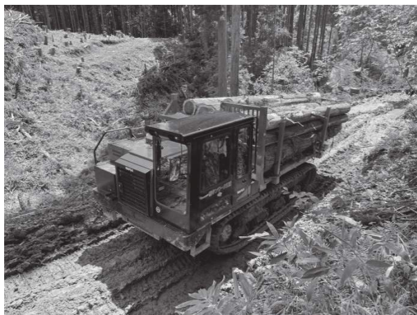
(フォワーダでの運材作業)
